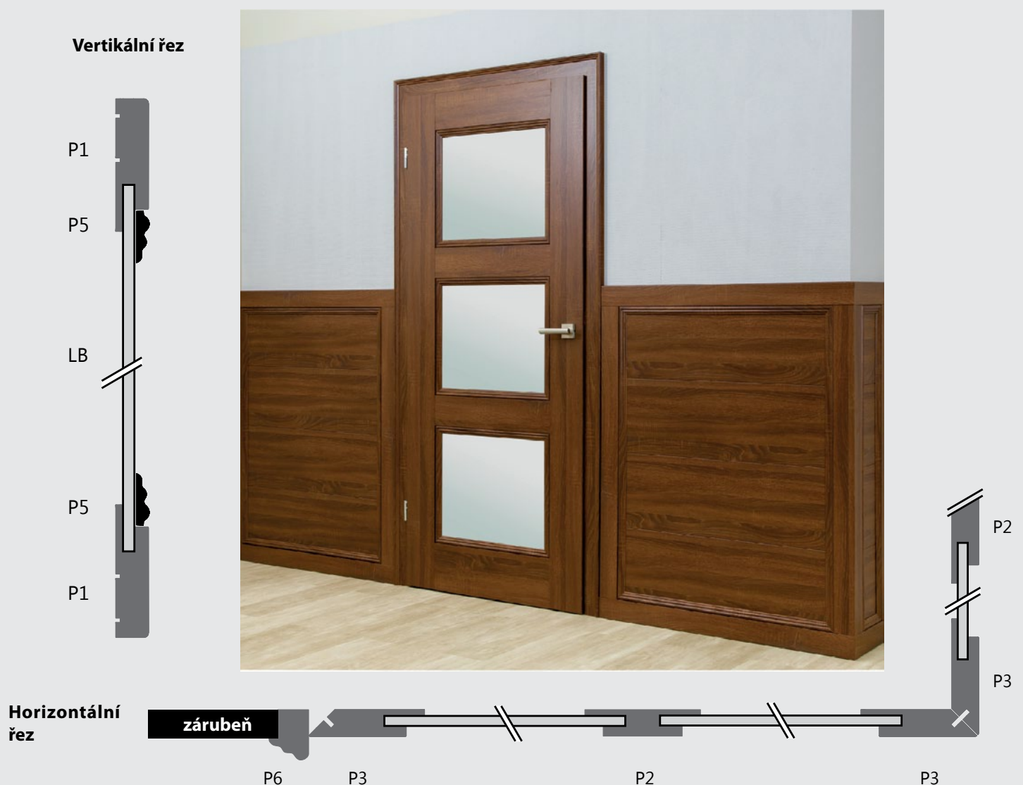
Schéma provedení rohového obkladu stěny
